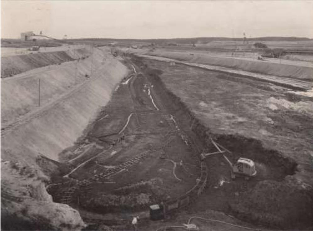
Rechts Abraumbaggerung mit Eimerkettenbagger, in der Mitte Abbau des Hauptflözes, links Rückverkipfung des Abraums. Rechts hinten die große Halde (Kippe), links hinten Kettenbahn und Brecher, Seilbahn über das Tagbaugelände.
